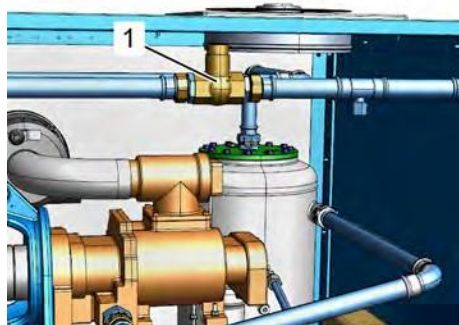
Рис. 18: Клапан минимального давления/обратный клапан
