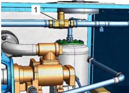
Рис. 18: Клапан минимального давления/обратный клапан
