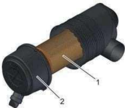
Рис. 37: Разборка корпуса воздушного фильтра
