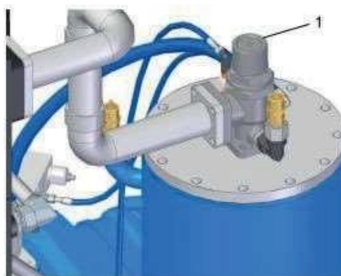
Рис. 10: Клапан минимального давления с функцией обратного клапана
