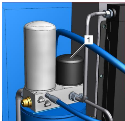
Рис. 22: Фильтр охлаждающей жидкости
