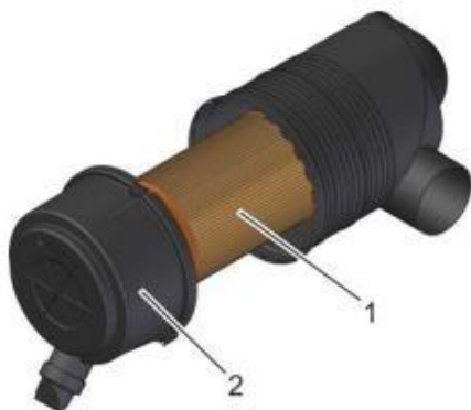
Рис. 38. Разборка корпуса воздушного фильтра
